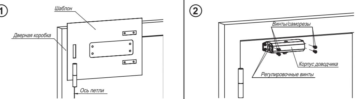
Совместите шаблон максимально точно по контуру дверного полотна/коробки и петель. Закрепите шаблон, например скотчем. Далее необходимо подготовить отверстия для установки доводчика.
