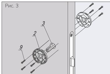
5. После закрепления оснований извлеките квадрат из отверстия и с его помощью выломайте ориентирующие элементы из центров оснований (рис. 3). Затем установите квадрат обратно в отверстие.
