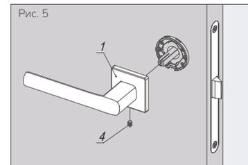
6. Установите дверные ручки и закрепите фиксирующие винты с помощью шестигранных ключей.
